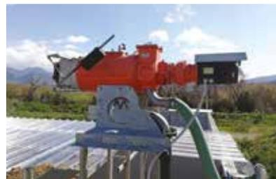
**Figura 12** - Separatore S/L meccanico a coclea (Fonte: Chiara Vecchio, impianto biogas sito in Capaccio Paestum, Giugno 2022)
